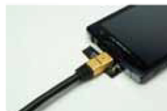
タイプ A プラグ側は一体型メタルシールドにより従来品に比べシールド効果、プラグ強度が増えています。
