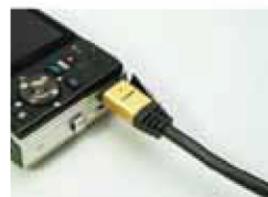
タイプ A プラグ側は一体型メタルシールドにより従来品に比べシールド効果、プラグ強度が増えています。
